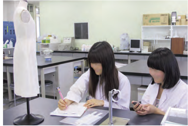
図4 ハートループ法で剛軟度測定
