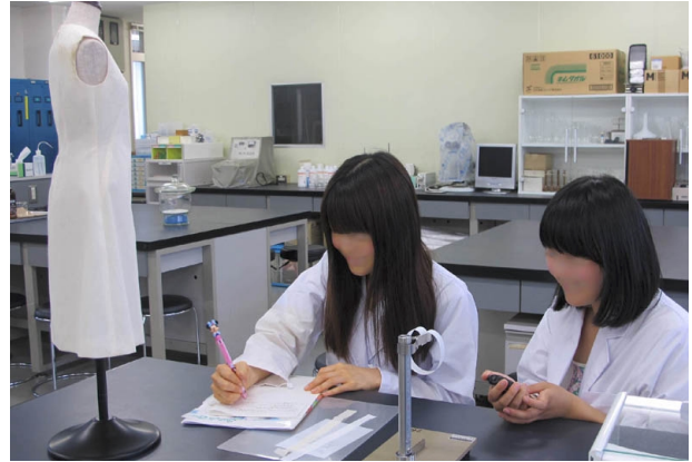
図4 ハートループ法で剛軟度測定
